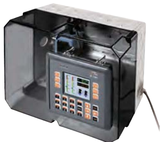
Корпус повышенной прочности со степенью защиты IP66: I-3625-ENC
